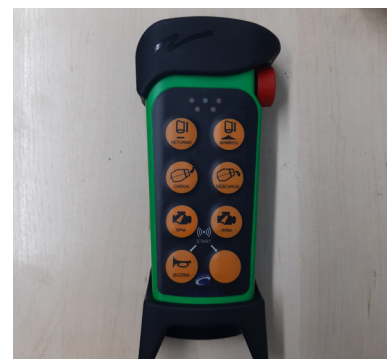
Mando a distancia (control de las funciones de la hormigonera y módulo del bombeo)
