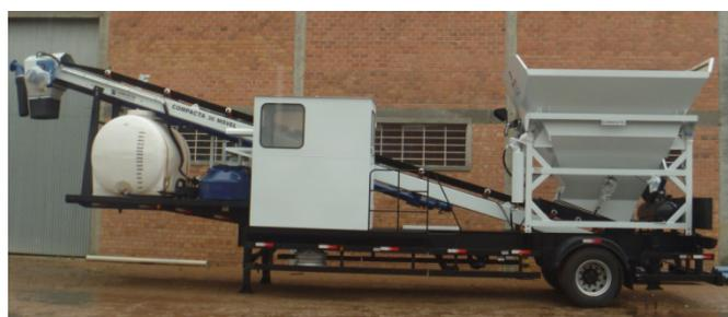
**Central Móvel C30 c/ Rasga Saco (30 a 45m³/h)**
