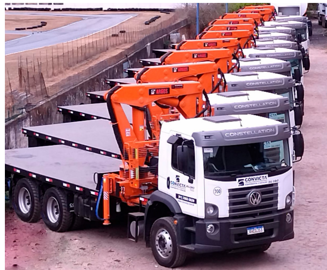
Caminhão Munck de 43 toneladas
