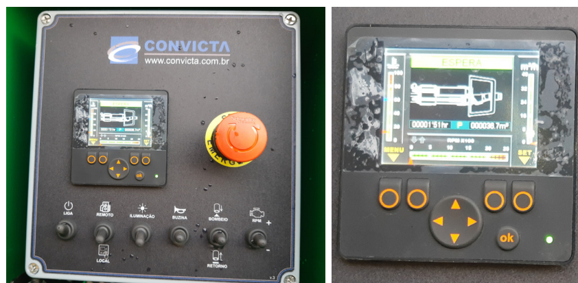
Painel de comando com Display de Led (contador de m 3 parcial e total, RPM e temperatura)
